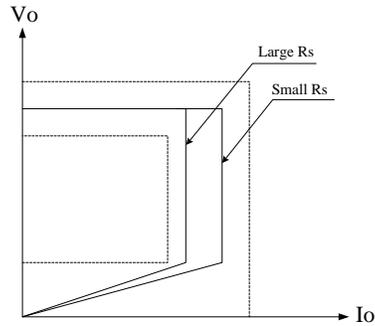
图 4 输出功率随 RS 的变化曲线
